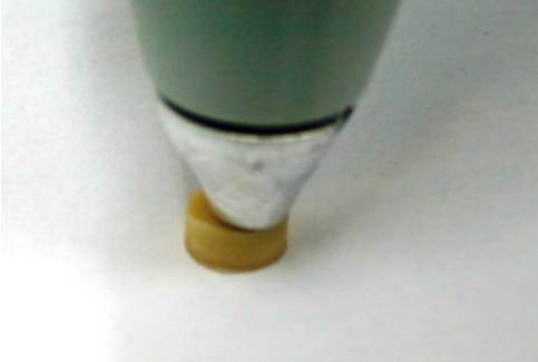
Fot. 5 Pomiar próbki za pomocą urządzenia Shade Star® Źródło: Archiwum własne.
