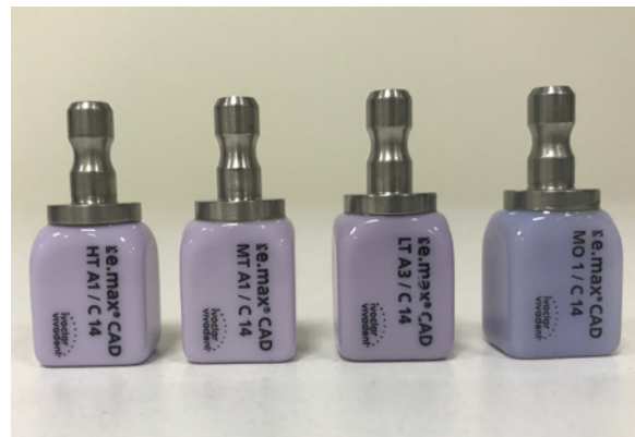
Fot. 3 Bloczki ceramiczne IPS e.max. Od lewej HT, MT, LT, MO Źródło: Dzięki uprzejmości Pracownia Protetyczna DentalScan, ul. Władysława Jagiełły 3/9, 50-201 Wrocław.
