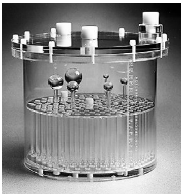
Rys. 6 Fantom Jaszczaka do oceny ogólnej wydajności systemu PET składający się z jednorodnej sekcji, prętów do oceny rozdzielczości przestrzennej oraz sfer do oceny kontrastu
